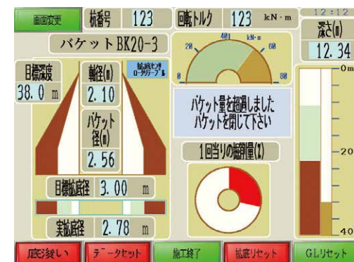
拡底部掘削時
