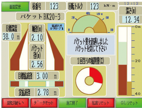
拡底部掘削時
